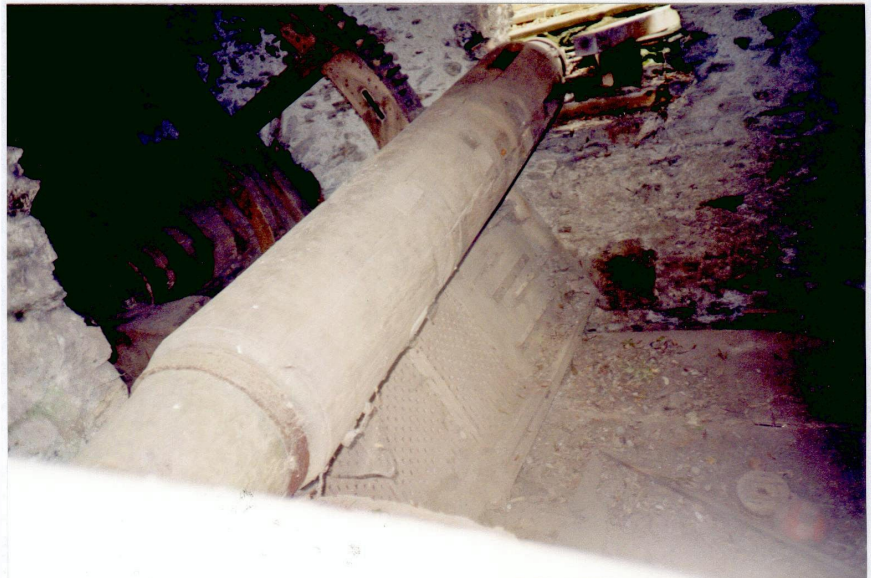
hölzerne Antriebswelle im inneren der ehemaligen Sägewerks der Goßberger Mühle
